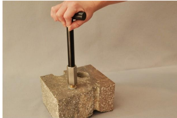
Figura 9. Removendo o FLX-VP
