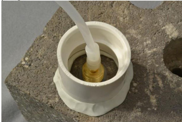
Figura 8. Barragem de água usada para detecção de vazamentos
