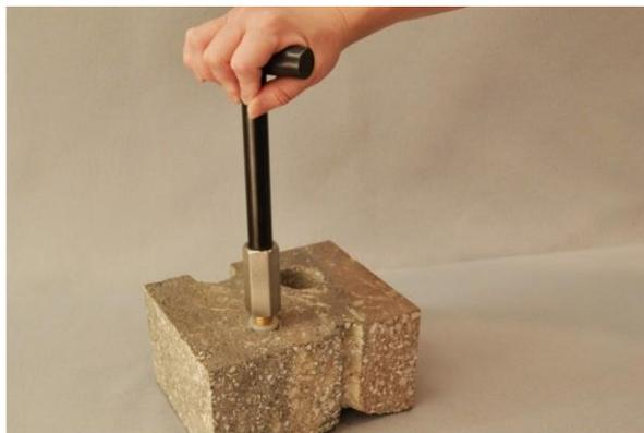
Figure 7. Extraction du Vapor Pin
