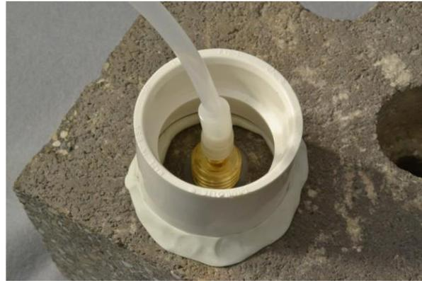
Figure 6. Barrage d'eau utilisé pour la détection de fuites
