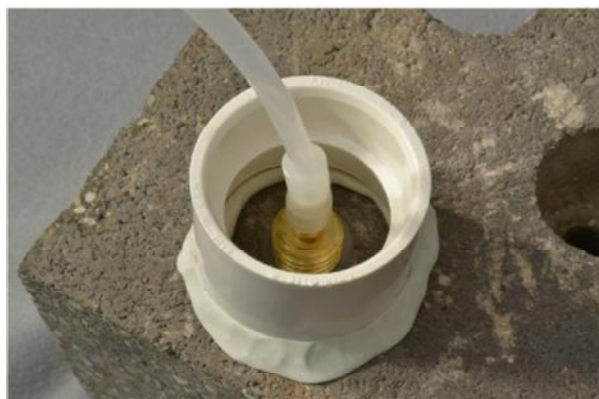
Figura 6. Reservatório de água usado para detectar vazamento.
