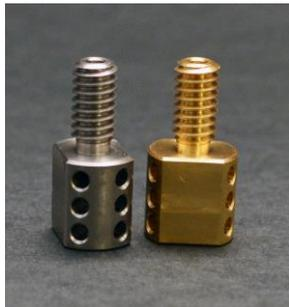
As **Válvulas com crivo Vapor Pin®** são anexados a extensões do próprio VAPOR PIN® para permitir a entrada de ar lateralmente. Eles são usados para evitar o entupimento do pino ou extensão quando as amostras são coletadas abaixo da laje. Os crivos são bastante robustos e podem ser cravados no cascalho ou detritos de cimento abaixo da laje. Os crivos permitem também que o VAPOR PIN® e extensões sejam apertados com uma chave inglesa.
