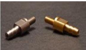
A **Extensão Barb Vapor Pin®** é uma espiga versátil utilizada para encaixar embaixo do VAPOR PIN®. A Extensão Barb é usada para conectar outros dispositivos tais como (tubos de aço inoxidável, plástico rígido, e filtros) utilizando um pequeno pedaço do Tubo Tygon para unir o dispositivo adicional junto ao VAPOR PIN®.
