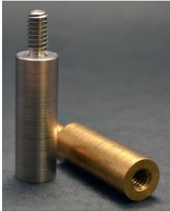
As **Extensões VAPOR PIN®** adicionam 3,8 cm ao comprimento do VAPOR PIN®. A extensão pode se unir a outra extensão para alcançar o comprimento e profundidade desejada. Os crivos ou filtros são recomendados como termino da extensão, de forma a evitar o entupimento quando a extensão encontra o material de fundo abaixo do contra piso.
