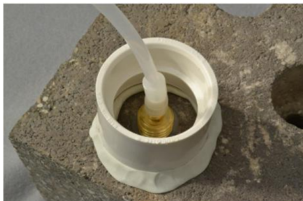
Figura 6. Reservatório de água usado para detectar vazamento.
