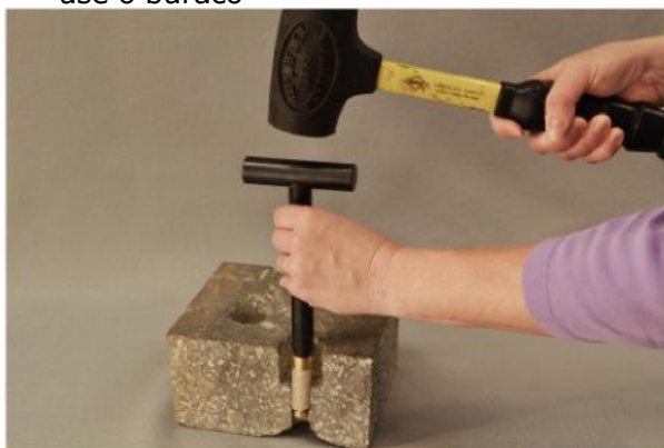
Figura 3. Instalação de montagem embutida.
