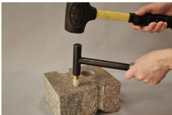
Figura 2. Instalação do Vapor Pin®.
