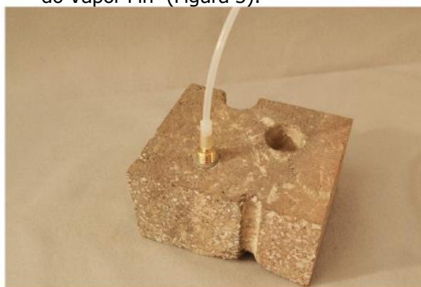
Figura 5. Conexão de amostra do Vapor Pin®.
