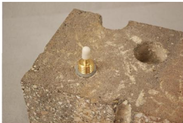
Figura 4. Vapor Pin® instalado.
